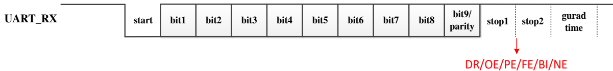
图 8-3 UART 接收器流程
