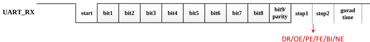
图 8-3 UART 接收器流程
